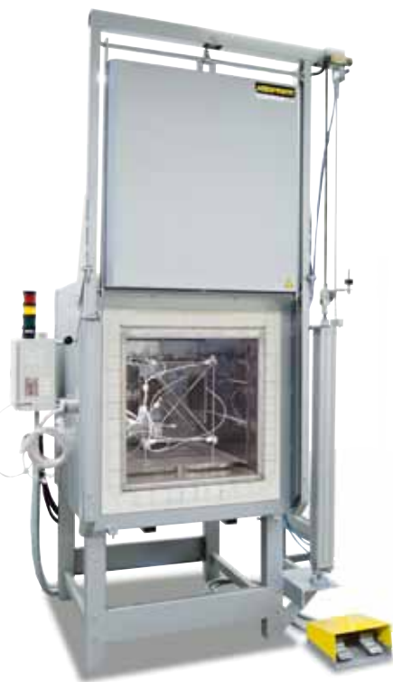
Измерительная рама для определения однородности температуры
